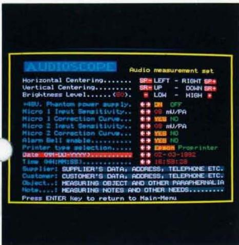
E' la pagina dei settaggi a piu' alto livello del 9000. Qui vengono definite la luminosita' video, il tipo di stampante adottato, etc. Vengono inoltre dichiarati i parametri relativi ai microfoni e, in basso, quattro righe con i dati della misura, che appariranno in tutte le stampe.
